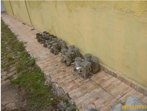
Foto 15 – Controle tecnológico do concreto.
