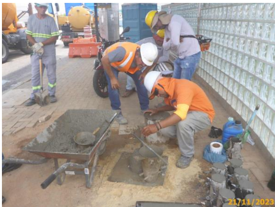
Foto 83 – Controle Tecnológico do concreto de Cimento Portland lançado na via da Linha Eixo BRT.
