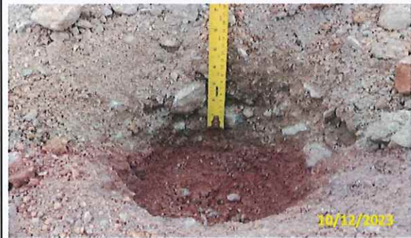
Foto 38 Análise da base após fresagem
