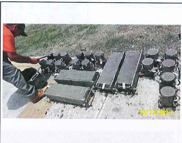
Foto 05 Moldagem dos corpos-de-prova
