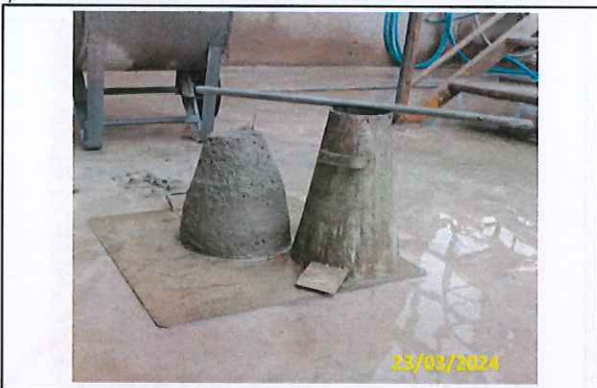
Foto 48 Slump test do concreto a ser utilizado
